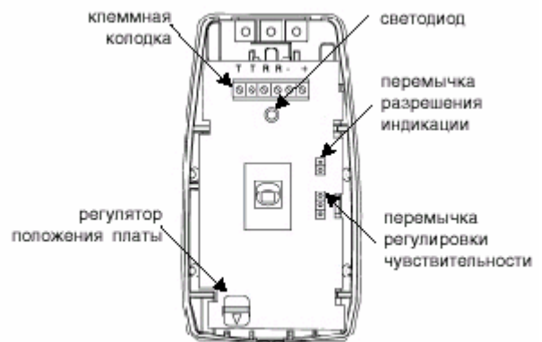
Рис. 2. Плата извещателя в корпусе.
